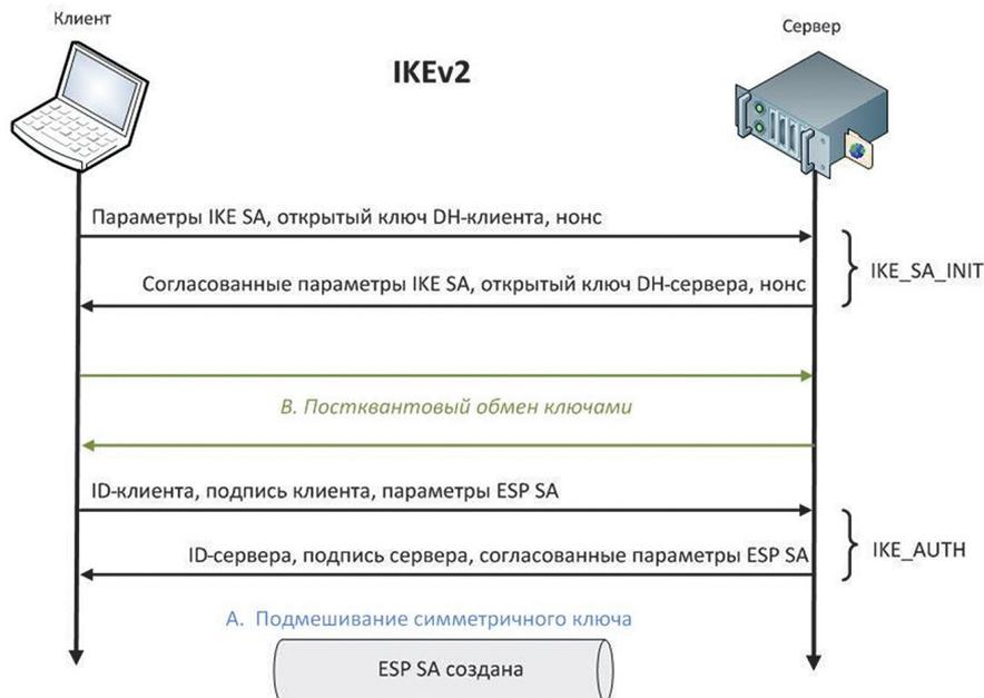
Рис. 3. Варианты противодействия квантовым компьютерам в IKEv2.
