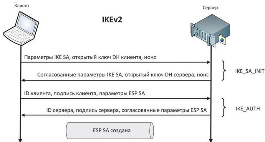
Рис. 2. Создание защищенного соединения в IKEv2.
