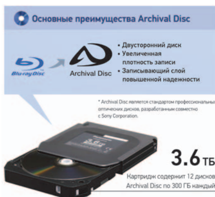
Рис. 1. Внешний вид картриджа с 12 оптическими дисками, изготовленными по технологии Archival Disc.
