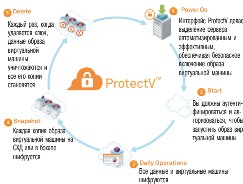
Рис. 2. ProtectV обеспечивает безопасность как самих данных виртуальной машины, так и ее образа на всех этапах использования.
