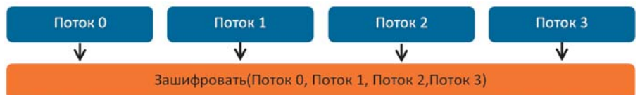
Рис. 2. Параллельная обработка четырех потоков шифрования на одном ядре ЦП.
