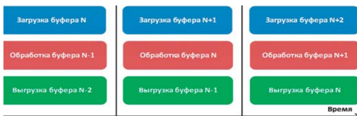
Рис. 4. Конвейеризация обработки данных на GPU.
