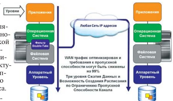
Рис. 1. За счет многоуровневой оптимизации реплицируемых данных требования к полосе пропускания могут быть снижены на 99%.
