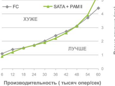
Рис. 10. Сравнение конфигурации FAS3160A на FC-дисках с эквивалентной конфигурацией по производительности с RAM-модулем (вверху) и аналогичных конфигураций с SATA-дисками (внизу).
