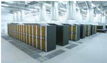
Рис. 9. Общий вид кластера HLRB II (установлен в 2007 г. в исследовательском центре Leibniz-Rechenzentrum (Германия) – 15 строка top500).
